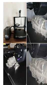
Figura 2. Proceso de impresión del molde colónico en TPU. (A) Impresora FDM Creality Ender-3 V3 acompañada de secadora de filamento para mantener el TPU libre de humedad. (B) Vista inicial de la pieza principal: el modelo hueco se imprime sobre soportes tipo árbol generados en Ultimaker Cura. (C) Impresión de segmentos adicionales del colon; se aprecia la correcta adherencia a la cama tras aplicar pegamento y control de temperatura. (D) Detalle del bloque extrusor durante la deposición de capas de 0.25 mm, con flujo continuo y sin oclusiones, lo que asegura la transparencia y flexibilidad del TPU.
