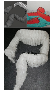
Figura 1. Flujo de diseño y prototipado inicial del simulador colónico. (A) Modelado anatómico en Blender, donde se optimizan curvaturas y calibre. (B) Laminado en Ultimaker Cura, con visualización de soportes y trayectoria de extrusión. (C) Primer prototipo impreso en TPU utilizado para verificar geometría, flexibilidad y adherencia de capas antes de la fabricación definitiva.
